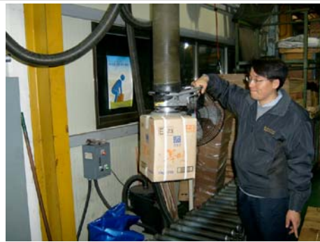
KEST VacuEasylift VM160 납품처 : 수석섬유, 품천섬유, 동국합섬, 청정원 대상식품 제품무게: 최고50kg 용 적재높이 : 1.7m
