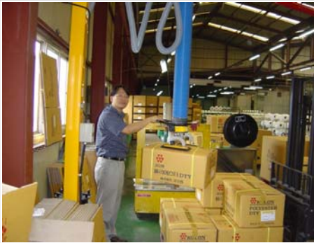
KEST VacuEasylift VM160 납품처 : 수석섬유, 품천섬유, 동국합섬, 청정원 대상식품 제품무게: 최고50kg 용 적재높이 : 1.7m
